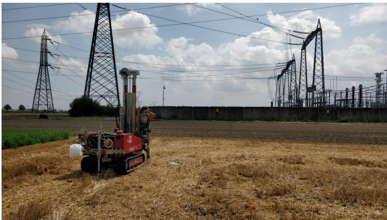
Prova (3) dinamica con Penetrometro Pagani
